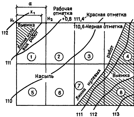
6.6. Схема разбивки местности при определении объемов планировочных работ методом четырехгранных призм. Цифры в кружках — номера фигур
